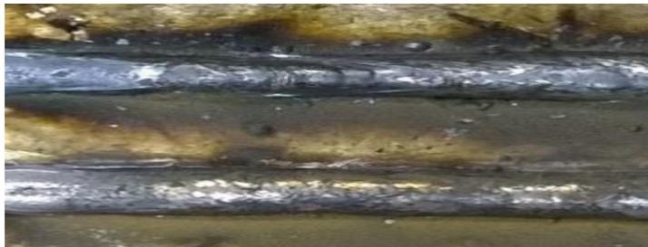
Рис. 3. Внешние виды наплавленных валиков при подаче электродной проволоки: 1 – непрерывной; 2 – импульсной
